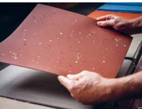
Linoleum besteht aus bis zu 98 Prozent organischen und mineralischen Materialien, Foto: Gerflor
